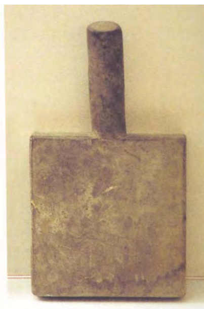
Molde y paleta para dar forma y alisar los azulejos. Museo de Cerámica de Manises.
