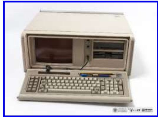
IBM Portable Personal Computer (1984-1986). Computador personal basado en el microprocesador Intel 8088
