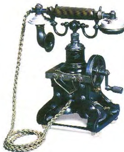
Modelo «Skeleton», llamada por magneto con sonería incorporada. En 1903 se fabricó uno con oro y marfil para el zar Nicolas II. Fabricado por L.M. Ericsson en Suecia, 1895.
