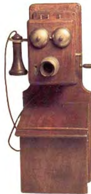
Teléfono mural con caja para contener dos pilas. Llamada por magneto. 1905-1910
