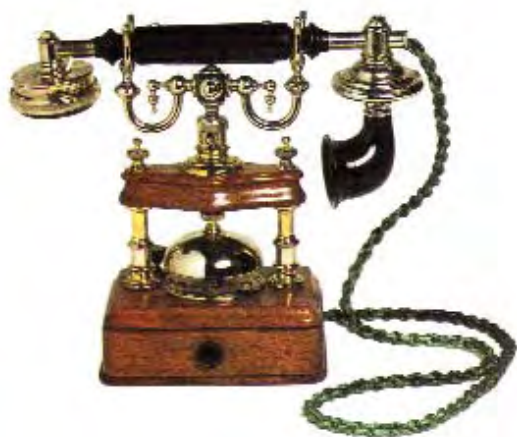
Aparato de sobremesa de madera de nogal con batería local y sonería incorporada. Muy solicitado en las grandes mansiones españolas. Fabricado por L.M. Ericsson en Suecia, 1895.
