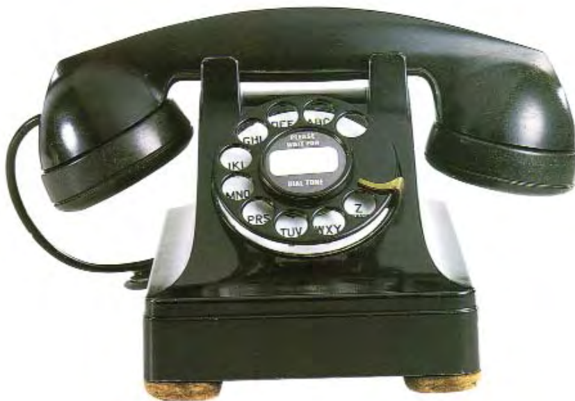
Teléfono de sobremesa de baquelita negra, batería central, con disco de llamada. Modelo americano de 1937.
