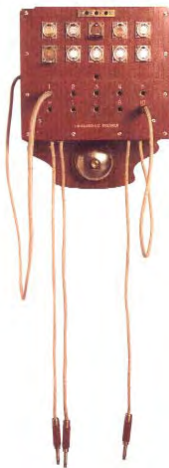
Centralita mural de batería local para diez posiciones. Fabricada por L.M. Ericsson en Suecia, 1909.
