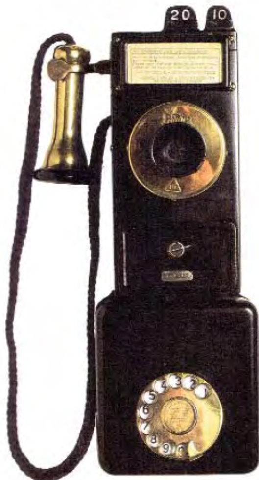
Teléfono público realizado en hierro. Modelo americano fabricado por Gray Telephone Pay Station Co. en 1927.
