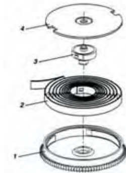
Resorte motor de un reloj de bolsillo: 1.- Cubo, 2.- Muelle real, 3.- Árbol de barrilete, 4.- Tapa de cubo.
