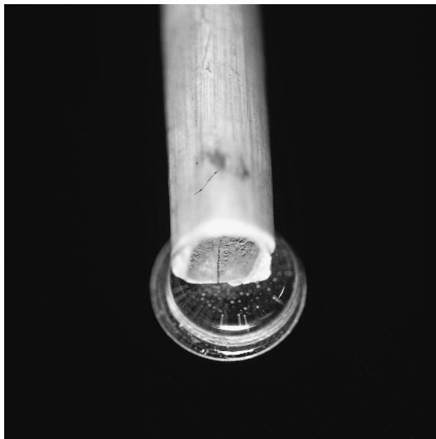
Foto 8. Restos de colorante adheridos, al interior y al exterior, en uno de los tubos experimentales, tras su utilización como "aerógrafos".
