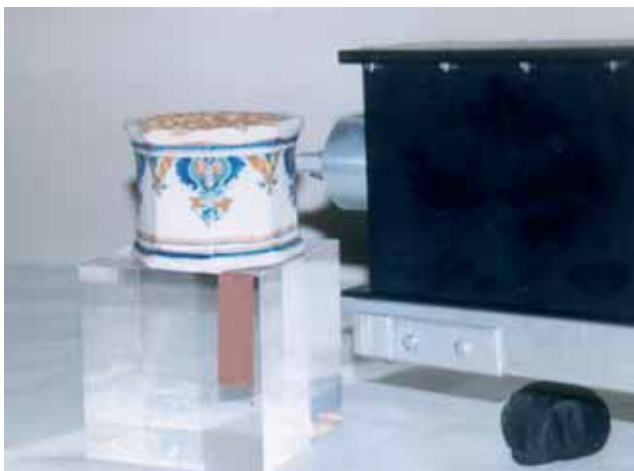
El espectrómetro se desplaza fácilmente donde está la obra para emitir la radiación.
